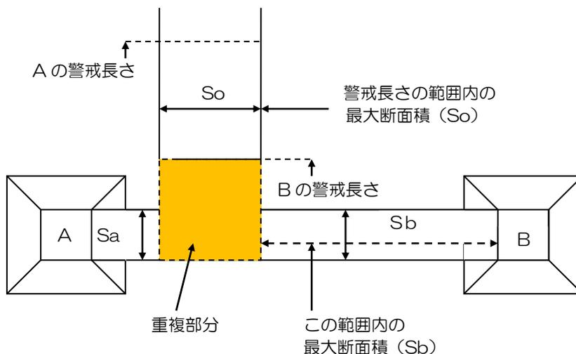
※ Aに設置するフード・ダクト用は、ダクトの公称防護断面積が $S_o$ 以上のものでなければならないが、Bに設置するフード・ダクト用はダクトの公称防護断面積が $S_b$ 以上のものとすることができる。
