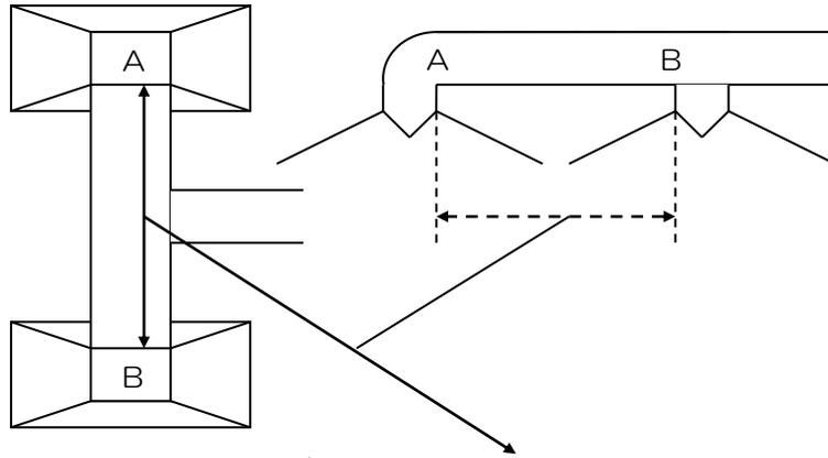
※ A、B間の距離が5m未満の場合、A、B双方のフード等用簡易自動消火装置を相互に連動させる。
