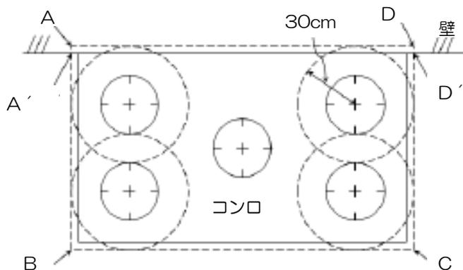
※ レンジが不燃材料等の壁に接して設置されている場合の被防護面積はA'、B、C、D'点を結んで得られる長方形の面積とする。
