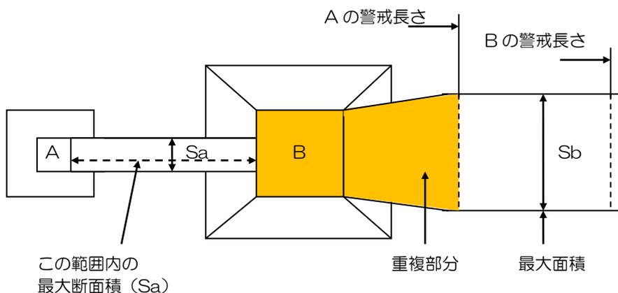
※ Bに設置するフード・ダクト用は、ダクトの公称防護断面積が $S_b$ 以上のものでなければならないが、Aに設置するフード・ダクト用はダクトの公称防護断面積が $S_a$ 以上のものとすることができる。
