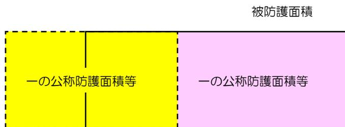
※ 同一型式の複数の消火装置を被防護面積等が警戒できるように設け、相互に連動させる
