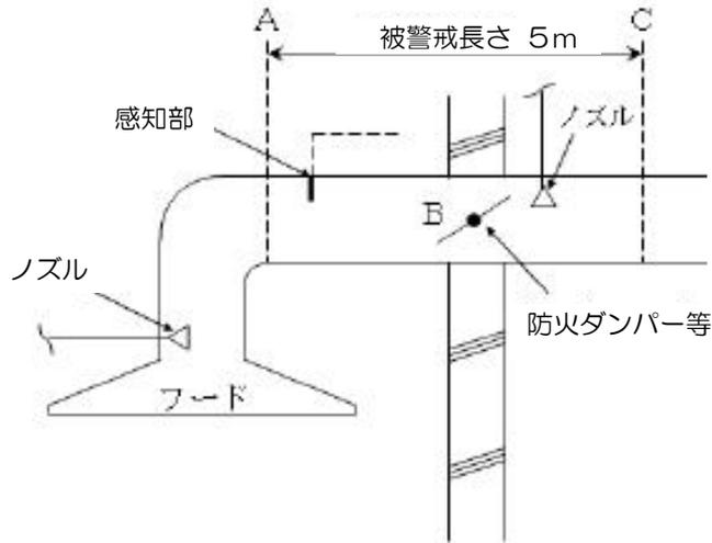
※ 被警戒長さ5mの途中に防火区画等のための防火ダンパー等が設置された場合において、防火ダンパー以降の排気側 (BからCの間) にも、認定品のダクト用を組み合わせ設置し警戒する例
