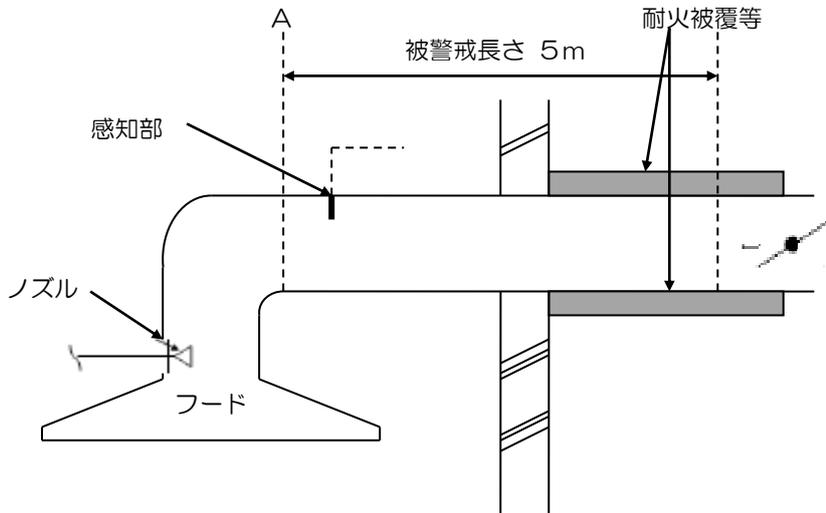
※ 防火ダンパーの設置位置を A から5m以上とし、耐火被覆等により要求される防火区画等を形成し、被警戒長さ5mを確保する例
